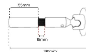
\*Ajuste de 15mm para cada fixador para nivelar o perfil SKY-1600
